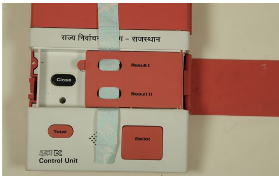
पिंक पेपर सील से Result Section के आन्तरिक कम्पार्टमेन्ट को सील करना
